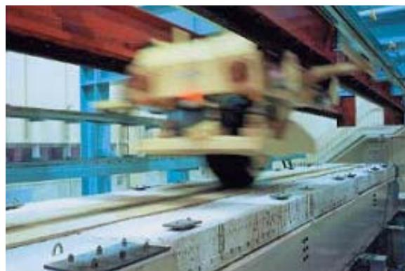
橋梁床版などの疲労耐久性を検証する移動荷重試験機
