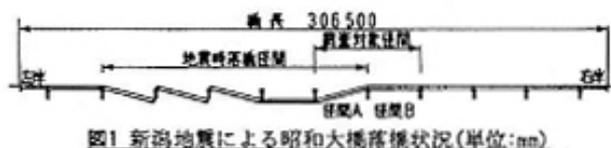
図1 新潟地震による昭和大橋落橋状況(単位:mm)
